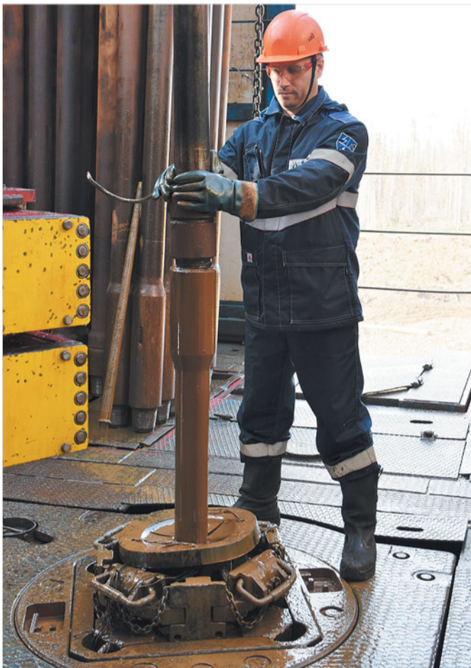
Бурильщик 6-го разряда ООО «БНГРЭ» Виталий Коваленко выполняет наращивание бурильного инструмента на КП-123
