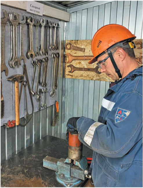
Слесарь по обслуживанию буровых 6-го разряда ООО «БНГРЭ» Виталий Баев выполняет дефектовку подшипника ленточного конвейера на КП-116
